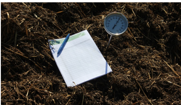
а) журнал фіксації замірів та біметалевий термометр
