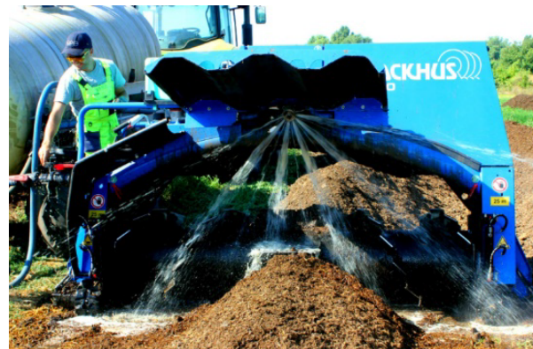
Рис. 5. Зволоження буртів за допомогою тягача з діркою CLAAS
